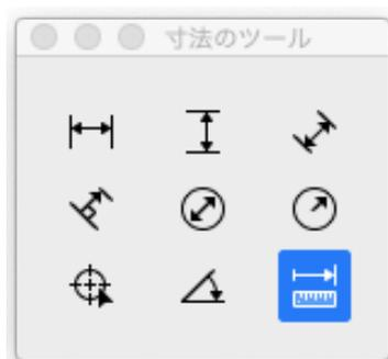
寸法パネルに「測定」ツールが追加されました。ツールを選択し、その後マウスボタンを押したままマウスを動かしてください。移動した距離が表示されます。
